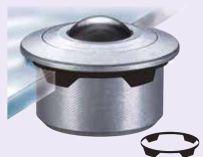
Angabe von Zusatz „K“ oder „C“ am Ende der Bestellnummer der Kugelrolle zur Lieferung des optionalen Sicherungsring (z. B. „L22K“ oder „L22C“). Bei Verwendung von Sicherungsring diesen in die Bohrung einsetzen und dann Kugelrolle durch den Ring drücken. Krallen am Rand weiten sich auf und halten die Kugelrolle sicher fest.
